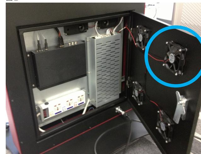
図①: 本体背面の裏扉を開けて頂きますと、○の部分にファンが搭載しております。
